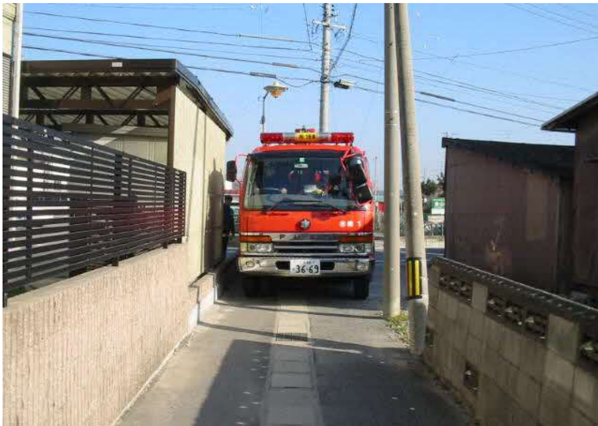
■幅員 4m未満道路での消防車（車幅：約 2.3m）（出典：岡崎市 HP）
